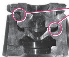
Pour les valves démontables, plusieurs zones ne peuvent être nettoyées qu'après démontage.
